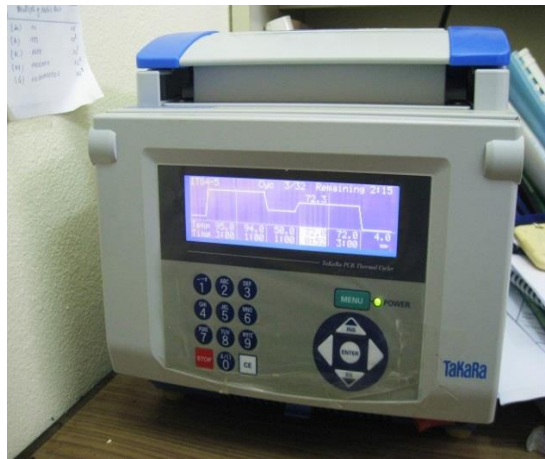
Máy phản ứng PCR hiệu Takara sử dụng để khuếch đại DNA
