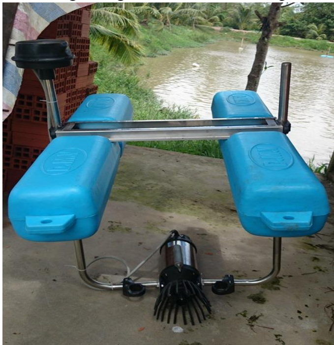
Hình 3.1: Máy sục khí chìm và khung cố định máy trong nước
